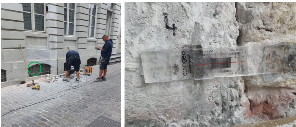
Positie scheurmeter onderaan Anjelierenstraat, detail scheurmeter +0 binnen
